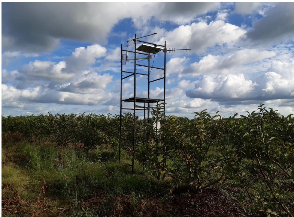
Figura 6. Estação Surface Renewal instalada em Russas – CE
